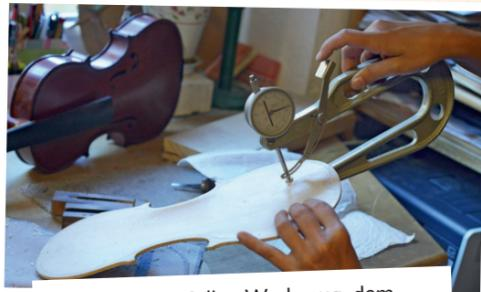
Mit einem speziellen Werkzeug, dem XXXXXX misst sie die Dicke des Bodens.
