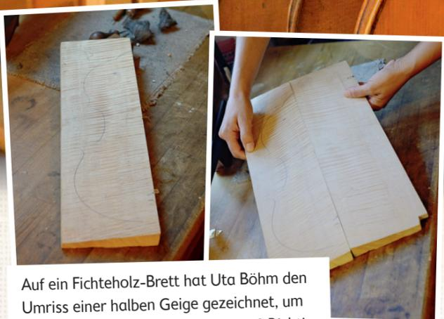
Auf ein Fichteholz-Brett hat Uta Böhm den Umriss einer halben Geige gezeichnet, um sie auszusägen. Einer halben Geige? Richtig gelesen! Der Geigenboden- bzw. Deckel wird nämlich (meistens) aus zwei Hälften gefertigt. Diese Hälften werden später aneinandergelimt.
