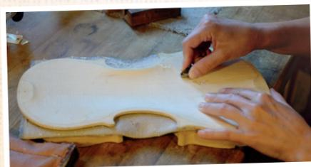
Jeder Geigeboden bzw. -Deckel hat eine leichte Wölbung nach außen. Um diese Wölbung zu bekommen, wird mit kleinen Hobeln nach und nach vorsichtig etwas Holz abgehobelt.
