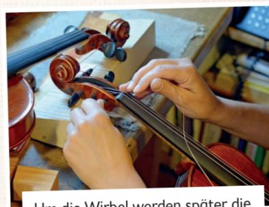
Um die Wirbel werden später die Saiten gewickelt. Man kann sie drehen, um die Saiten zu spannen und so auf den richtigen Ton zu stimmen.
