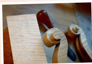
Aus einem weiteren Holzstück wird die sogenannte „Schnecke“ gefertigt.
