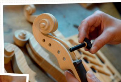
Die Schnecke ist sozusagen der Kopf des Geigenhalses, der später auf das Griffbrett gesteckt wird. An ihr werden die sogenannten „Wirbel“ befestigt.
